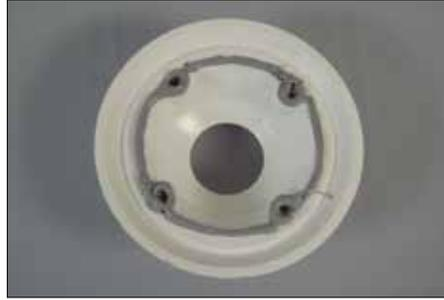
**2** Appliquez un cordon d'adhésif KERDI-FIX d'un quart à trois huitièmes de pouce (6 à 10 mm) sur bride existante et placez-y l'anneau de l'adaptateur. Remettez les écrous en les serrant uniformément à la main, puis d'un quart de tour de plus. Évitez de trop serrer, car cela pourrait endommager l'adaptateur et provoquer des fuites.
