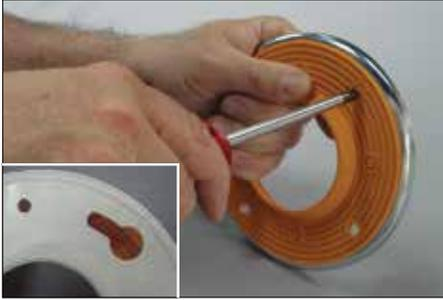
**1** Retirez l'anneau de serrage du drain déjà en place et conservez les boulons. Alignez les trous de l'anneau de serrage avec les trous prédécoupés de l'adaptateur et percez les trous à travers l'adaptateur.
